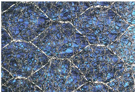
Le geostuoie sono principalmente impiegate con funzione antierosiva negli interventi di sistemazione idraulico-forestale e di consolidamento di pendii instabili.
