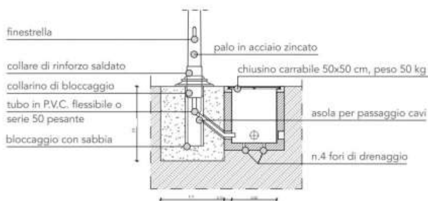
Figura 1: dettaglio plinto di fondazione
