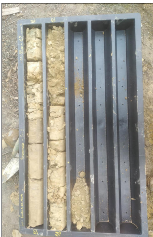
Sondaggio Geognostico S1 Cassetta Cat. 1.3 da 10,0 m a 12,2 m da p.c.
