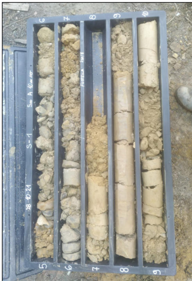
Sondaggio Geognostico S1 Cassetta Cat. 1.2 da 5,0 m a 10,0 m da p.c.
