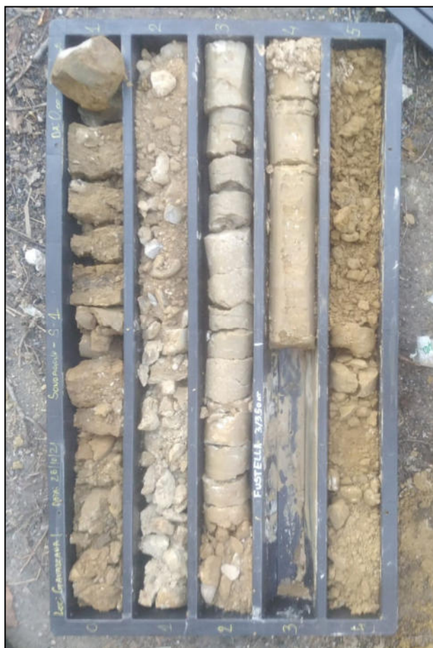
Sondaggio Geognostico S1 Cassetta Cat. 1.1 da 0,0 m a 5,0 m da p.c.
